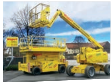
Scherenarbeitsbühne & Gelenkteleskop S220-25 / GT 200 D/E Hybrid
