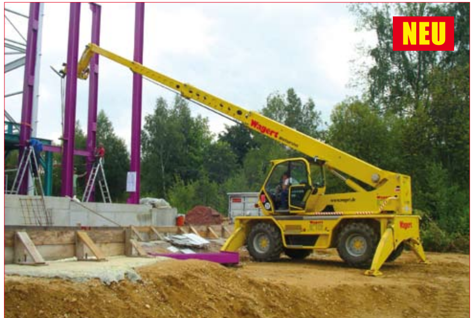
Teleskopstapler TS 45-21 ROTO: Tragkraft 4,5 Tonnen, Hubhöhe 21,0 Meter
