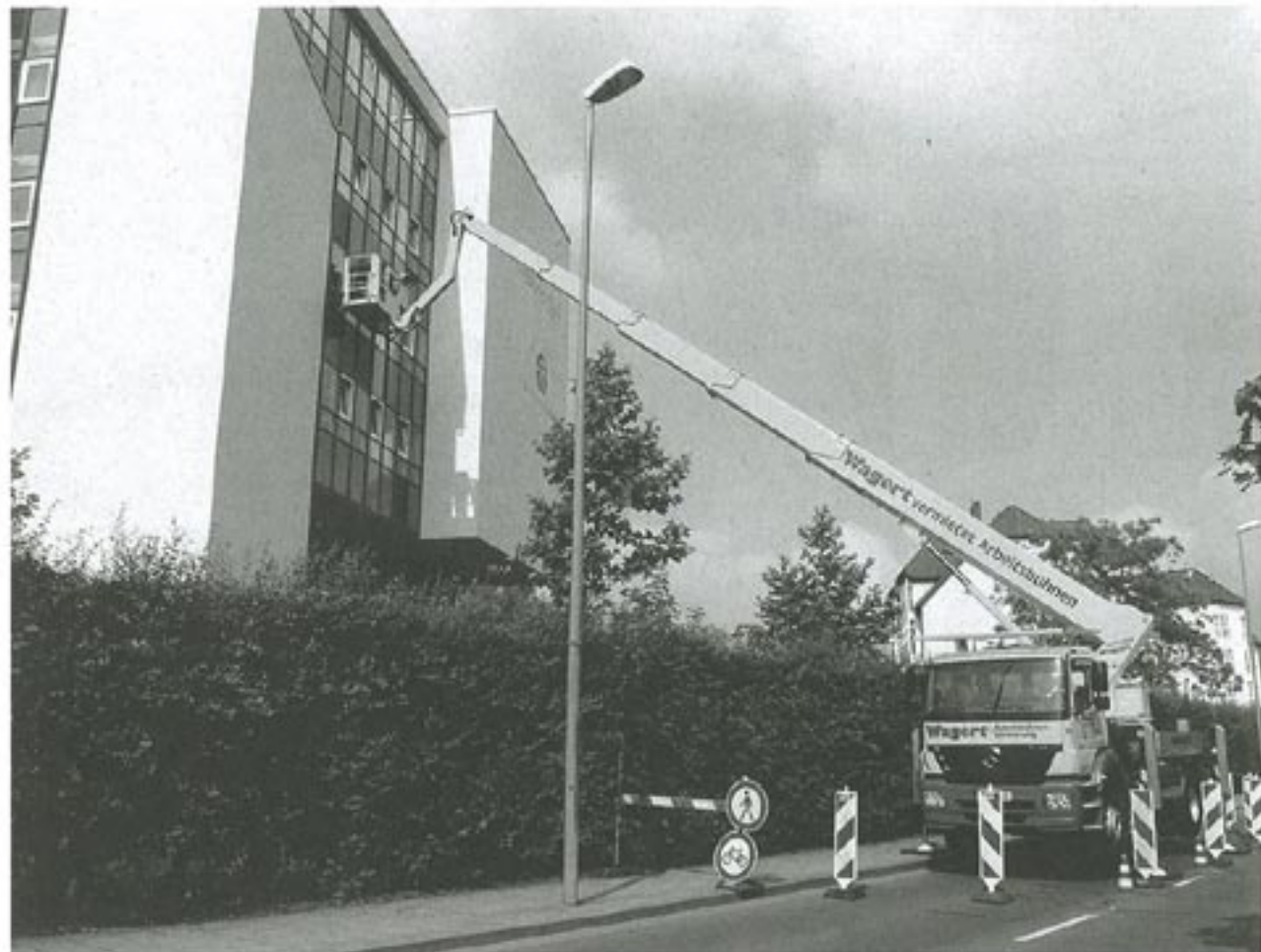
Zum Einsatz kam eine Lkw-Arbeitsbühne vom Typ L 350 K2, die eine Arbeitshöhe von 35 m und eine seitliche Reichweite von bis zu 28,50 m bietet. Foto: Wagert
